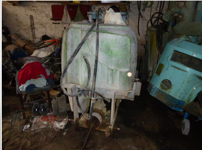
un appareil à sulfater porté 400 litres
